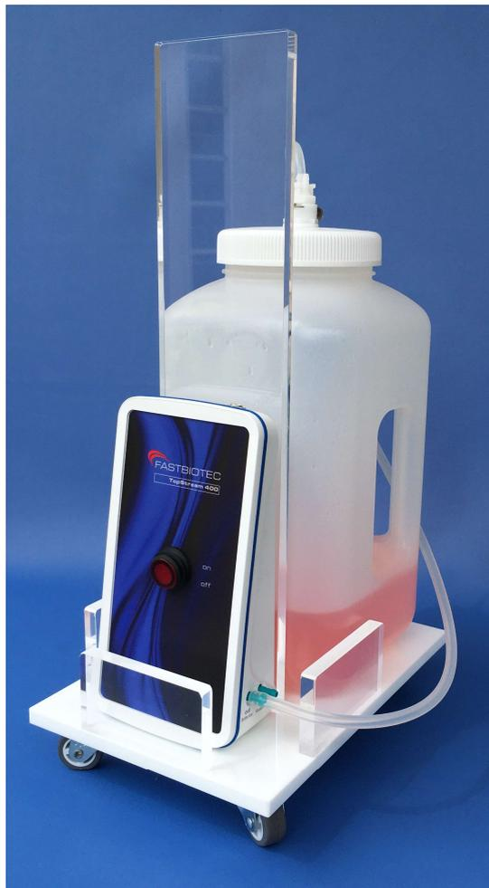
Förderung von biologischen Flüssigkeiten mit TopStream 400 direkt an der Thermo scientific Sicherheitswerkbank, ein geschlossenes System mit Qualitätsstandard für die Pharmaindustrie
