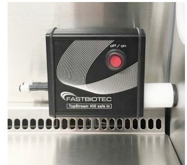
In der Sicherheitswerkbank Thermo Scientific Herasafe 2030i, wie sie im Uniklinikum Augsburg zum Einsatz kommt, ist das Absaugsystem (Detailansicht rechts) integriert. Bild: FASTBIOTEC
