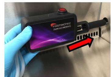
Netzstecker in die Strombuchse der Pumpe stecken, Halterstange mit dem Pumpengehäuse verschrauben und die Haltestange durch die Öffnung der Seitenwand stecken.
