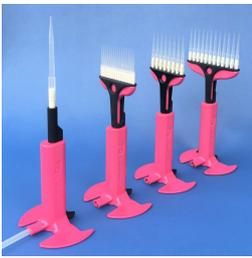
**Absaug-Pipetten** mit Spitzen-Abwurf,
