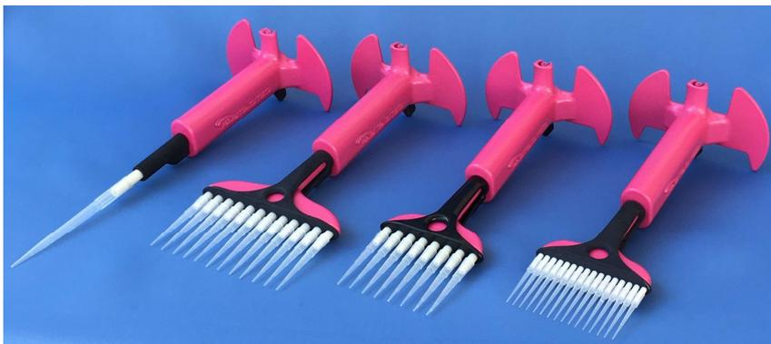
Absaugpipetten 1-, 8 -, 12 -,16 - Kanal mit Abwurf für Tips
