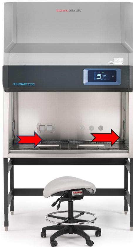
Wandhalterung mit doppelseitigen Klebeband, voll belastbar nach 60 min. Klebeflächen in der Sicherheitswerkbank mit Alkohol reinigen und trocknen lassen
