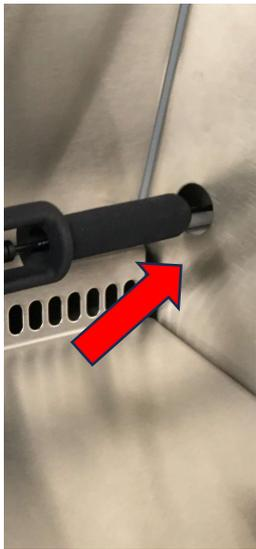
Durchführung an der Seitenwand öffnen und die Haltestange durchführen
