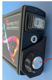
Gewindeadapter für die Halterung mit Mutter
