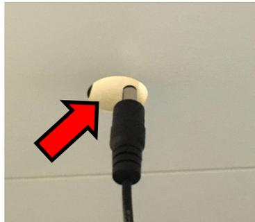
Von außen den Netzstecker in den Arbeitsraum der Herasafe führen
