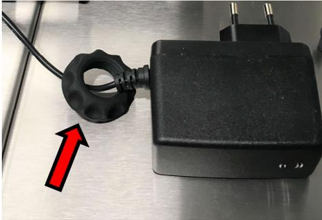
Netzsteckerkabel durch die Halte-Mutter stecken, die Mutter wird zum Schluss von außen verschraubt
